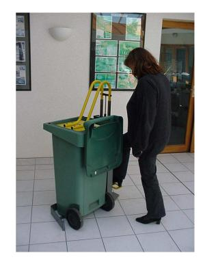
Force exercée par la masse de la personne avec remontée automatique du presseur
